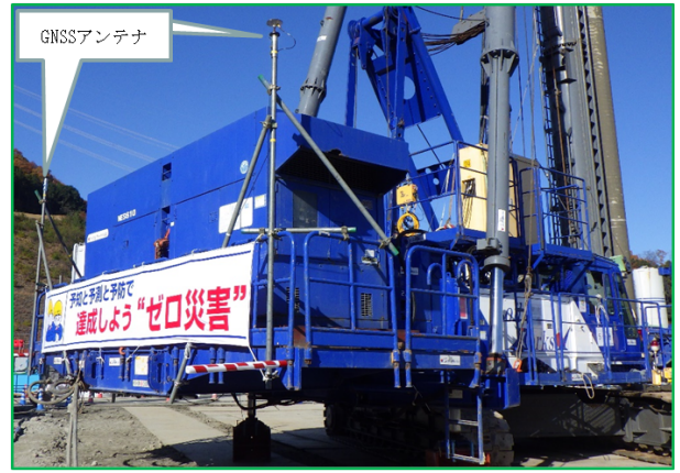
写真-4 GNSS アンテナの取り付け例
