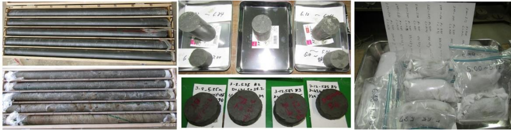
図-2 試験に用いたボーリングコアと供試体の状況
