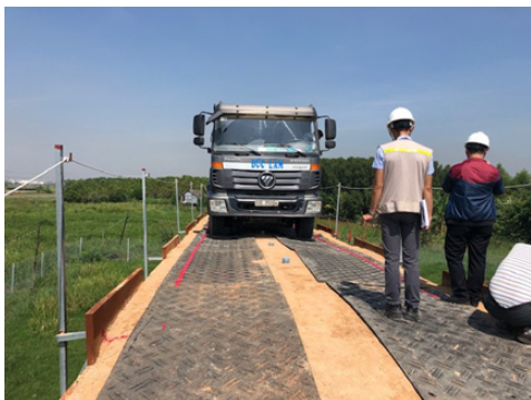
写真-1. ダンプ載荷試験 試験状況
