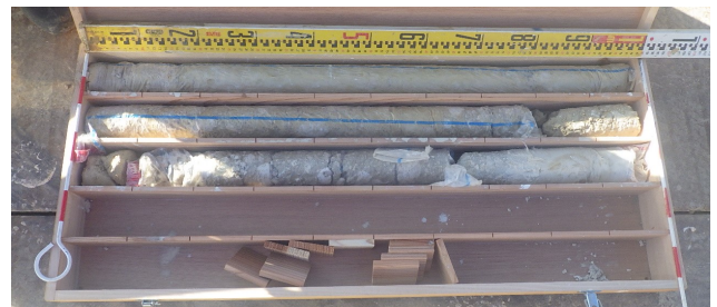
写真-6 採取された改良体コアの一例 (改良長 3.0m)
