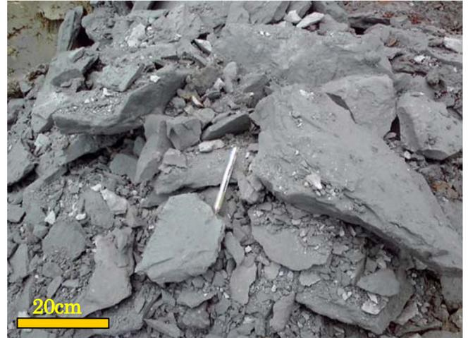
写真-1 試料採取した岩塊の状態
